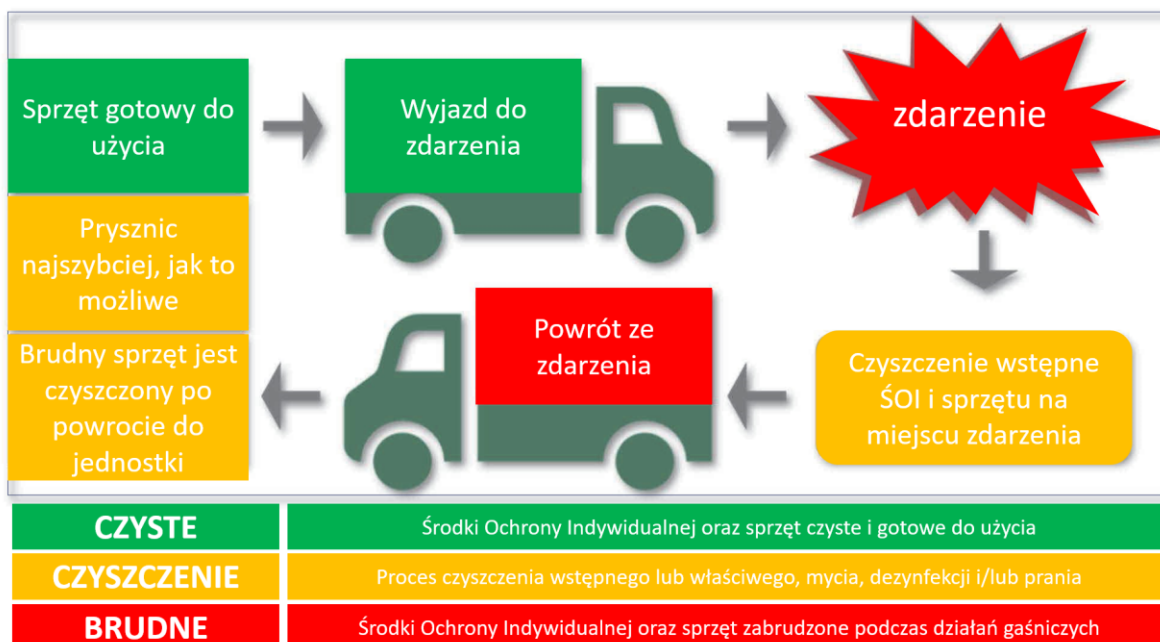
Rys. 3: Schemat ideowy pokazujący ogólną zasadę łańcucha kontroli zanieczyszczeń od momentu powstania zanieczyszczenia do momentu przywrócenia gotowości operacyjnej, w tym odpowiedniego poziomu higieny 1 .
